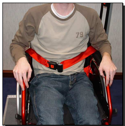
Abbildung 1: Falsch angelegter Beckengurt
