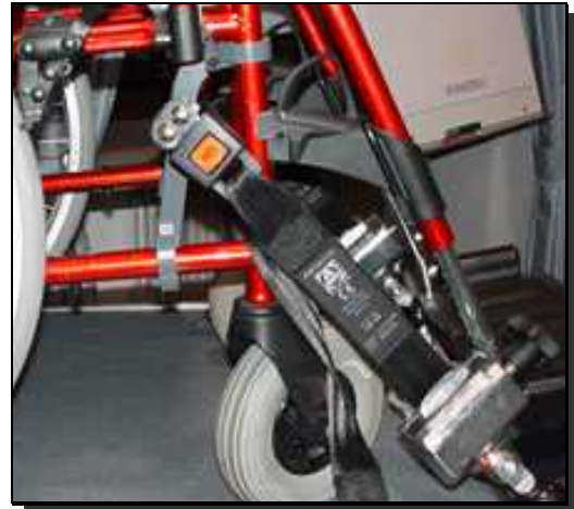
Abbildung 3: Rückhaltesystem (Kraftknotensystem) nach DIN 75078 Teil 2 vorne
