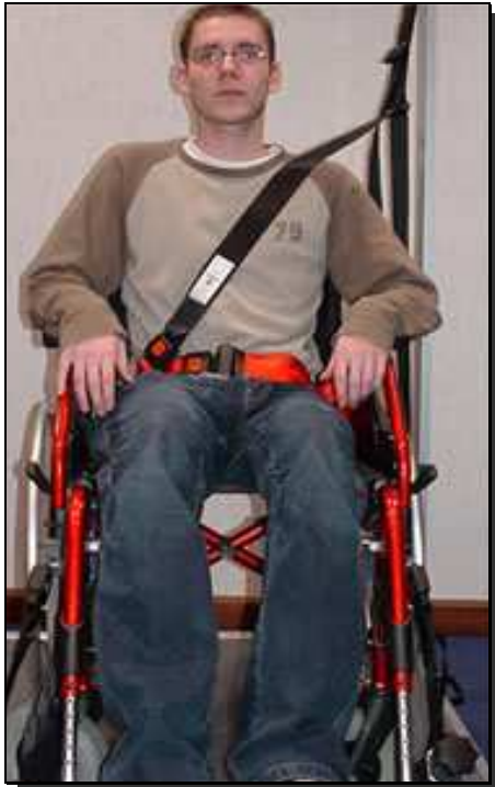
Abbildung 4: Personenrückhaltesystem nach DIN 75078 Teil 2, Beckengurt mit Gurtzunge für Schultersträgurgurt (3-Punkt-Gurt)
